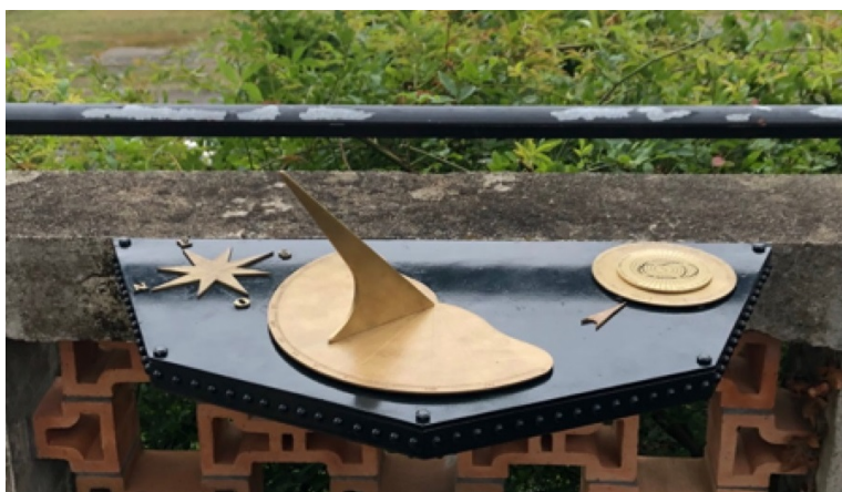
FIGURE 7 – L'ensemble gnomonique réhabilité. On notera que le style n'est pas aussi biseauté que souhaitable (et souhaité), mais il a évidemment été tenu compte, par les services techniques de la ville de Nantes, de considérations non scientifiques, notamment dans le domaine de la sécurité des visiteurs.
