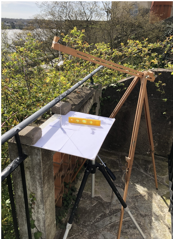
FIGURE 2 – Dispositif de détermination du méridien local par observation de l’ombre d’un fil à plomb sur une surface horizontale à midi solaire.
