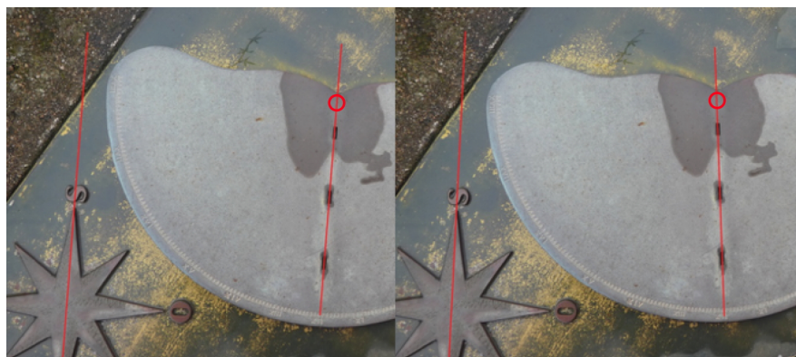
FIGURE 4 – Les deux positions extrêmes du mouvement d’oscillation horizontale du cadran (à gauche la ligne de midi est parallèle au méridien de la rose des vents ; à droite, elle est décalée d’environ 4,5°. Le cercle rouge indique le centre gnomonique qui est confondu avec l’axe vertical de rotation de la table.
