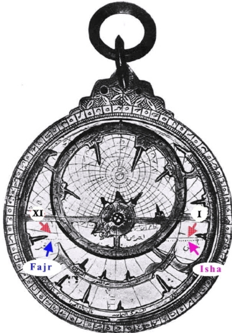
Fig.12 : Pour comparaison : un astrolabe NON-maghrebo-andalou (Egypte du XVIIe siècle) où les prières de Fajr et Isha ne sont pas représentés à la même hauteur. Notez que les courbes d'heures temporaires (flèches en pointillé rouge), qui ne correspondent pas au même système de projection, ne servent ici qu'à illustrer graphiquement la non-symétrie des prières de la nuit. ►
