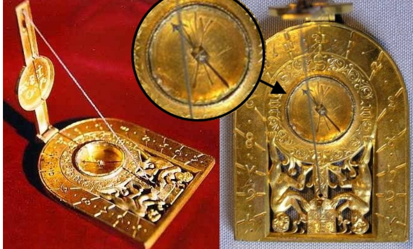
Fig. 2 : Le cadran construit en 1451 par Georg Peurbach pour l'Empereur Frédéric III. La photo de droite montre le fond de la boussole où apparaît une ligne oblique par rapport au Nord et qui marque la déclinaison magnétique. Cette ligne est d'origine. (photos de : http://members.aon.at/sundials/bild2e.htm )
