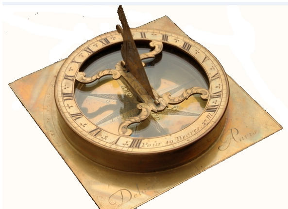
Fig. 11 Le cadran ASTO236 de Greenwich, c'est l'anneau des heures (solidaire du style) qu'il faut faire tourner par rapport à la boussole pour corriger la déclinaison (photo : http://prints.rmg.co.uk/artist/30331/claude-delure , description dans Higton, 2002).
