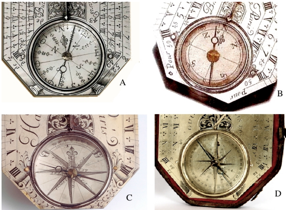
Fig. 13 : Différents dispositifs de correction de la déclinaison magnétique sur des cadrans Butterfield. A : Rotation de la boussole ; B : présence d'un petit repère ; C : repère + graduation fine à proximité du Nord pour s'adapter à la variation séculaire ; D : Index réglable (« aiguille de déclinaison ») ici en position N-S.
