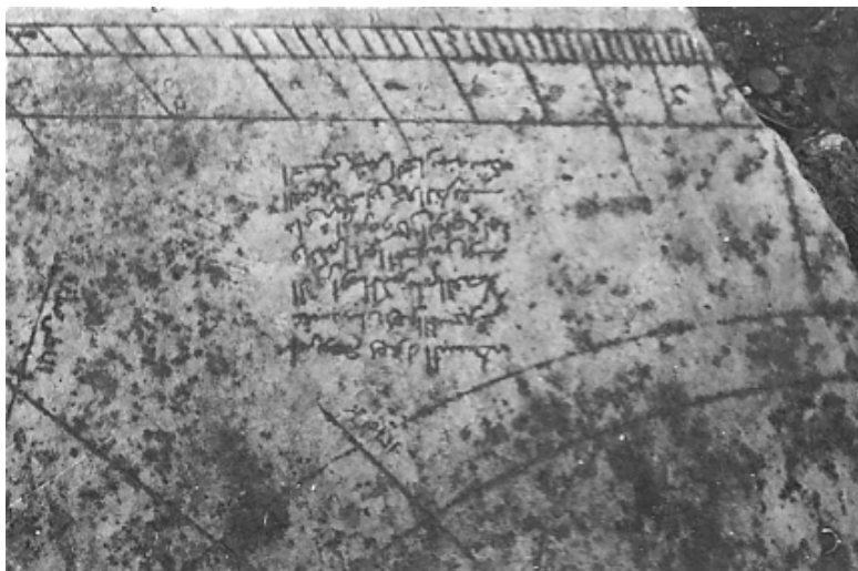
◀ Fig . 1 - Vue partielle du cadran disparu de Yûsuf Dey (1616/17). Il s'agit du premier cadran de l'époque moderne en Tunisie. On y distingue notamment: (1) le bandeau extérieur en heure égale, en relation avec un gnomon polaire et (2), et dans l'espace central (bas de la photo) des droites «annonçant» des repères de prières (heures italiques et babyloniennes) en relation avec un gnomon vertical.
