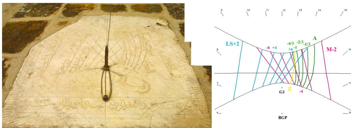
Fig. 10 : Le cadran de la Mosquée de Testour (photo : Mohamed Béji Ben Mami [http://www.discoverislamicart.org]) et sa modélisation. BGP= base du gnomon polaire (fil).
