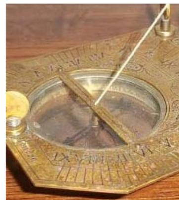
Fig. 13 : Exemple, sur un cadran du XXe siècle, de dispositif faisant correspondre le point bas d'implantation d'un fil polaire avec le centre de la boussole. Dans le cas du diptyque en ivoire, aucune trace d'un tel dispositif n'est visible... le mystère demeure sur la nature du point d'implantation. ►
