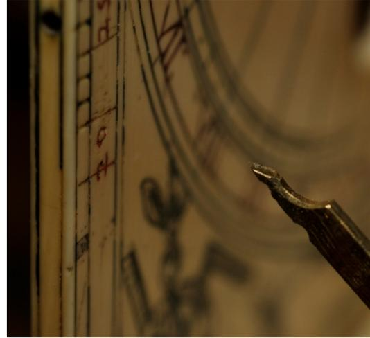
\*\* L'essentiel de l'espace est occupé par un cadran vertical qui doit être en relation avec un fil polaire dont on distingue le point d'implantation « haut » à la convergence des lignes horaires.
