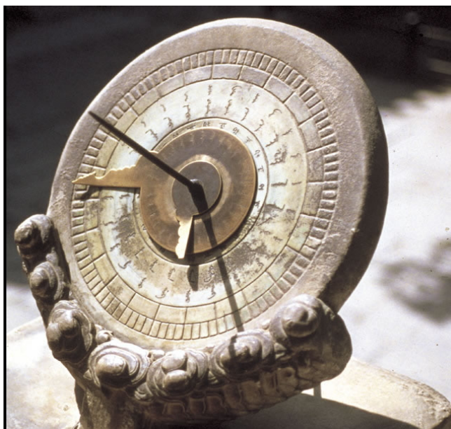
Figure 7 – Cadran équatorial chinois (Pékin) daté de la première moitié de la dynastie Qing (1644-1911) [Hollenback 2004]. On remarque les deux volvelles du calendrier perpétuel central. Ici le découpage horaire est en \frac{1}{2} heures, mais dans de nombreux cadrans chinois anciens, le découpage se fait en paire d'heures [Deng 2015].
