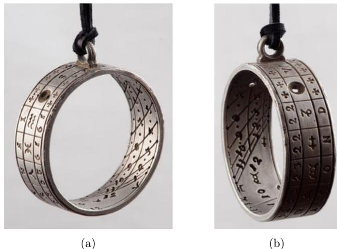
FIGURE 27 – Deux vues de sens opposé de la reproduction de l'anneau prussien de 1704 ([shepherdswatch.com](http://shepherdswatch.com)) : comme sur l'anneau de Fine, il y a un œilleton pour l'été et un pour l'hiver (marqués ici par les lettres S et W : Sommer & Winter en allemand), par ailleurs le tracé intérieur correspondant parfaitement à la construction de Fine, mais ajusté à  $51^\circ$  N.
