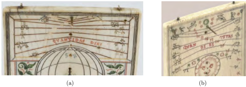
FIGURE 6 – Exemple de tracés imprécis des neuf arcs de déclinaison du cadran vertical (voir texte). (a) : les arcs sont matérialisés par les lignes brisées (Hans Tucher, c. 1630, Museum of Applied Arts-Budapest, inv. 69.291.1). (b) : Certains arcs sont indiqués mais pas tracés (11 h et 13 h) et les autres sont assimilés aux changements de signes (Vente Christie's, Sept. 2008, Leonhart Miller, 1652).
