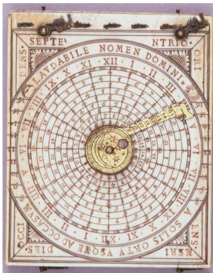
Figure 10 – Instrument de transformation des heures à la française (à l'extérieur : deux fois I à XII) en heure de Nuremberg selon la durée conventionnelle du jour (8 à 16 sur l'alidade). British Museum, face Ia du diptyque inv. 1888,1201.286 . (CC BY-NC-SA 4.0). À noter que la face IIb de ce diptyque est équipée d'un instrument du même genre dédié à la transformation heures à la française / heures inégales.
