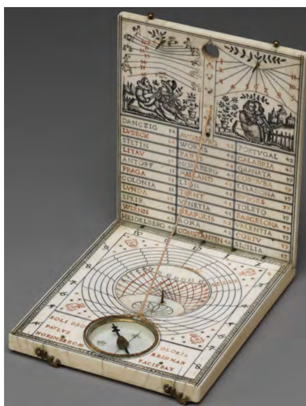
FIGURE 8 – Exemple de diptyque réunissant plusieurs cadrans. Le principal, qui se déploie sur la face IIa est un cadran horizontal indiquant des heures à la française, il est utilisable pour plusieurs latitudes (39°, 42°, 45°, 48° et 51°). En son centre 2 petits cadrans imbriqués indiquent les heures italiennes (en noir) et babyloniennes (en rouge) pour une latitude unique (Nuremberg ?). En haut à gauche de la face Ib, on note le cadran vertical à 9 arcs de déclinaison (pour Nuremberg) et à droite, un cadran en heures inégales (MET, inv. 03.21.24, Paulus Reinman 1602).
