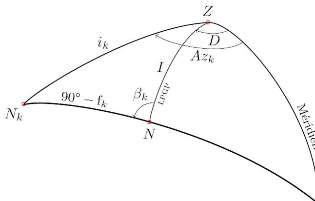
Figure 1 : Correspondance entre les paires  $(Az_k; i_k)$  et  $(\beta_k; f_k)$  dans le triangle sphérique  $ZNN_k$ . Z est le zénith du lieu, N est la normale au plan incliné déclinant et  $N_k$  l'extrémité du style oblique  $F_k$ .
