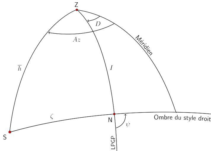
Figure 4. Définition des angles psi et zêta dans le triangle sphérique de position ZSN.
